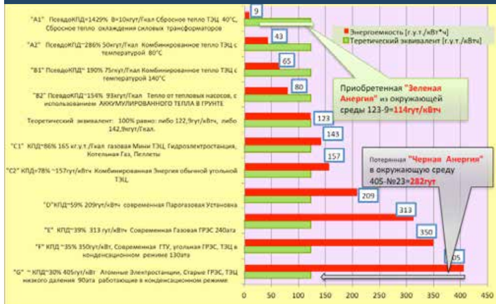
Рис. 3. Классификация качества энергоёмкости (A, B, C, D, E, F, G) потребляемой тепловой и электрической энергии
